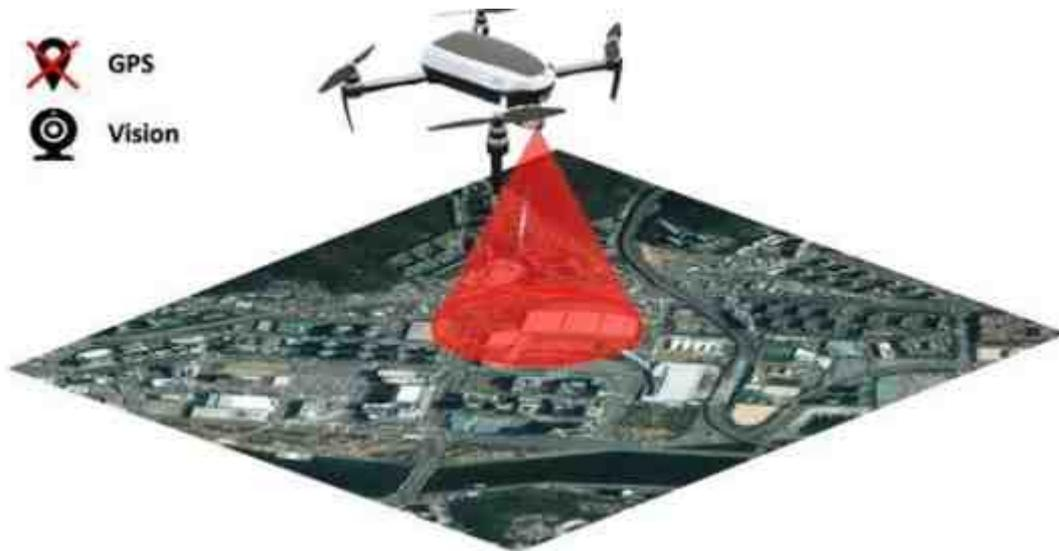
[그림] 영상항법시스템(Visual Positioning System)
