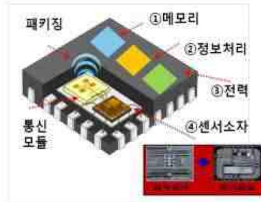
[그림] IoT 스마트 센서의 구성
