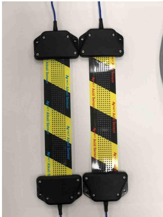
[그림] 엔시티의 화학물질 감지 스마트 센서
