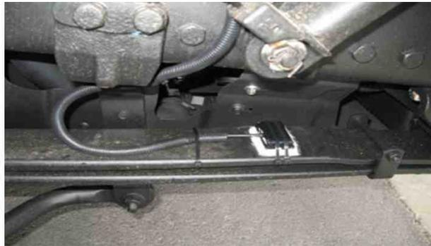
[그림] 중량 센서 설치 모습
